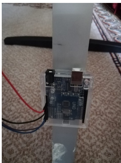
Figura 7.24 Montaj placa Arduino UNO R3 CH340 [contribuție proprie]
