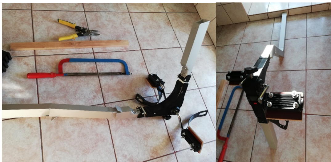
Figura 7.17 Brațe construite din profilul de aluminiu atașate la pedalier [contribuție proprie]
