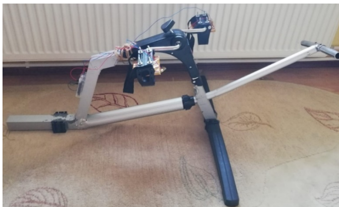
Figura 7.21 Construirea și montarea axului central de echilibrare și susținere ghidon telescopic [contribuție proprie]
